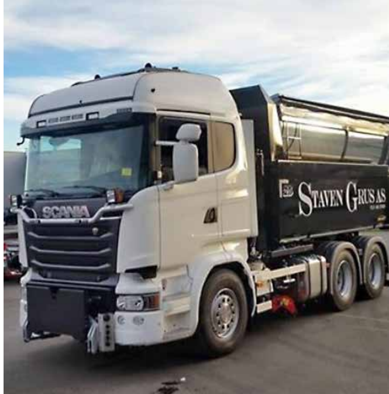
Staven Grus , Myre. Bilen har følgende utstyr fra Mählers: Plogfeste, HB3 høvelskjær m/system 2000, MC2-styring med styrespak til både høvelskjær og frontplog, armstøtte tilpasset vår styring og diagnose-skjerm samt ploghydraulikken. Bil nr. 2 er under oppbygging hos samme påbygger og har tilsvarende utstyr.
